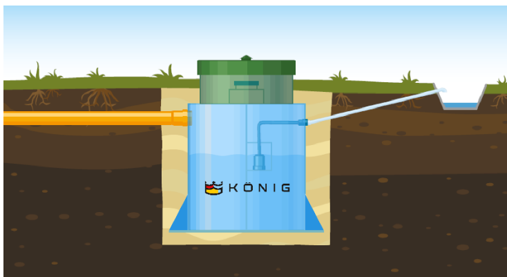
Вариант 2: Монтаж с принудительным отводом сточных вод в дренажную канаву. Слабовпитывающий грунт (суглинок, глина).
